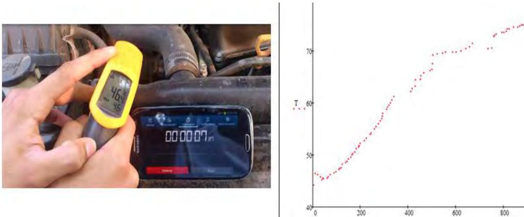
Figura 9. Datos del sistema de enfriamiento y su gráfica
