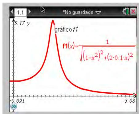
Figura 3. Factor de amplificación del efecto dinámico.
