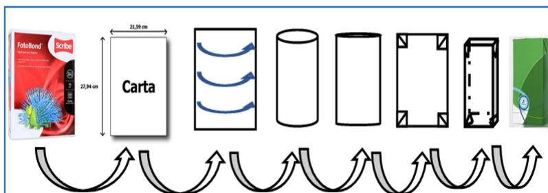
Figura 4. Secuencia de construcción y armado del recipiente paralelepípedo a partir de una hoja tamaño carta.
